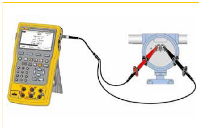
图 4. Fluke 754 与 HART 智能变送器通讯 - 仅通讯
