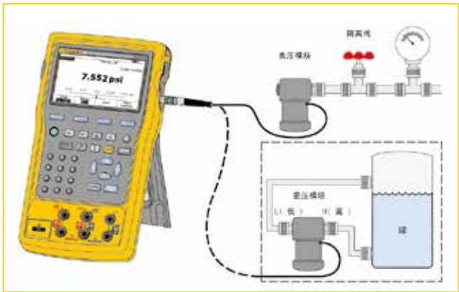
图 14. Fluke 754 测量压力的典型配置 测量压力 选择适当的压力模块连至校准器就可测量压力，压力可以以 Psi mmHg, inHg, inH 2 O, ftH 2 O, bar, kPa 或 mH 2 O 等单位来显示。
