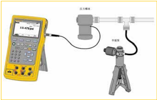
图 16. Fluke 754 输出压力的典型配置 输出压力 压力来自于外部压力源（如手泵）。当压力增大或减小时，可即刻在校准器上读出压力的变化。
