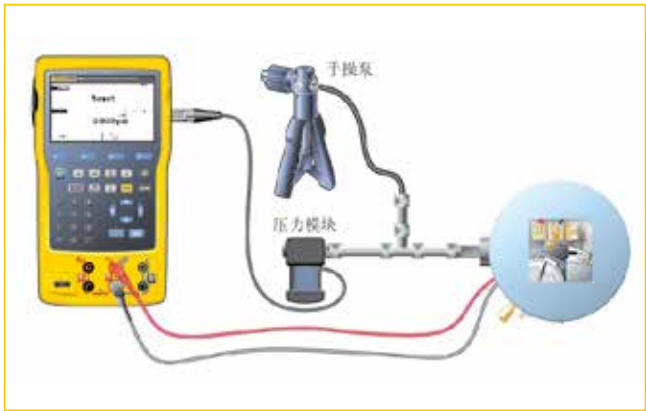
图 18. Fluke 754 校验压力开关 校准仪压力开关
