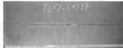
图 1 未使用 EMS 的铸坯低倍照片
