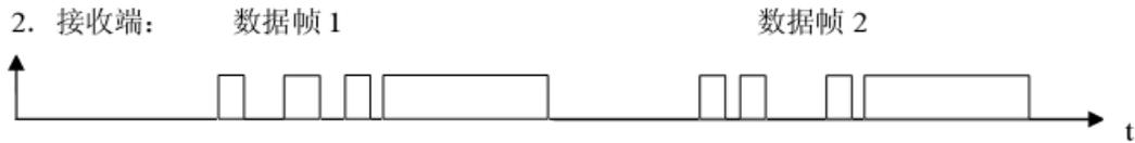
图 2 连续串行数据通过异步通道后产生的中断和延时
