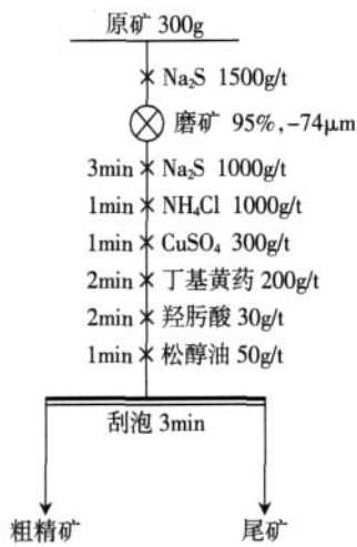
图 1 浮选初始条件和粗选开路流程
