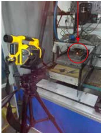
TiX1000+ 微距镜头 3 在离目标 90 cm 进行检测。
