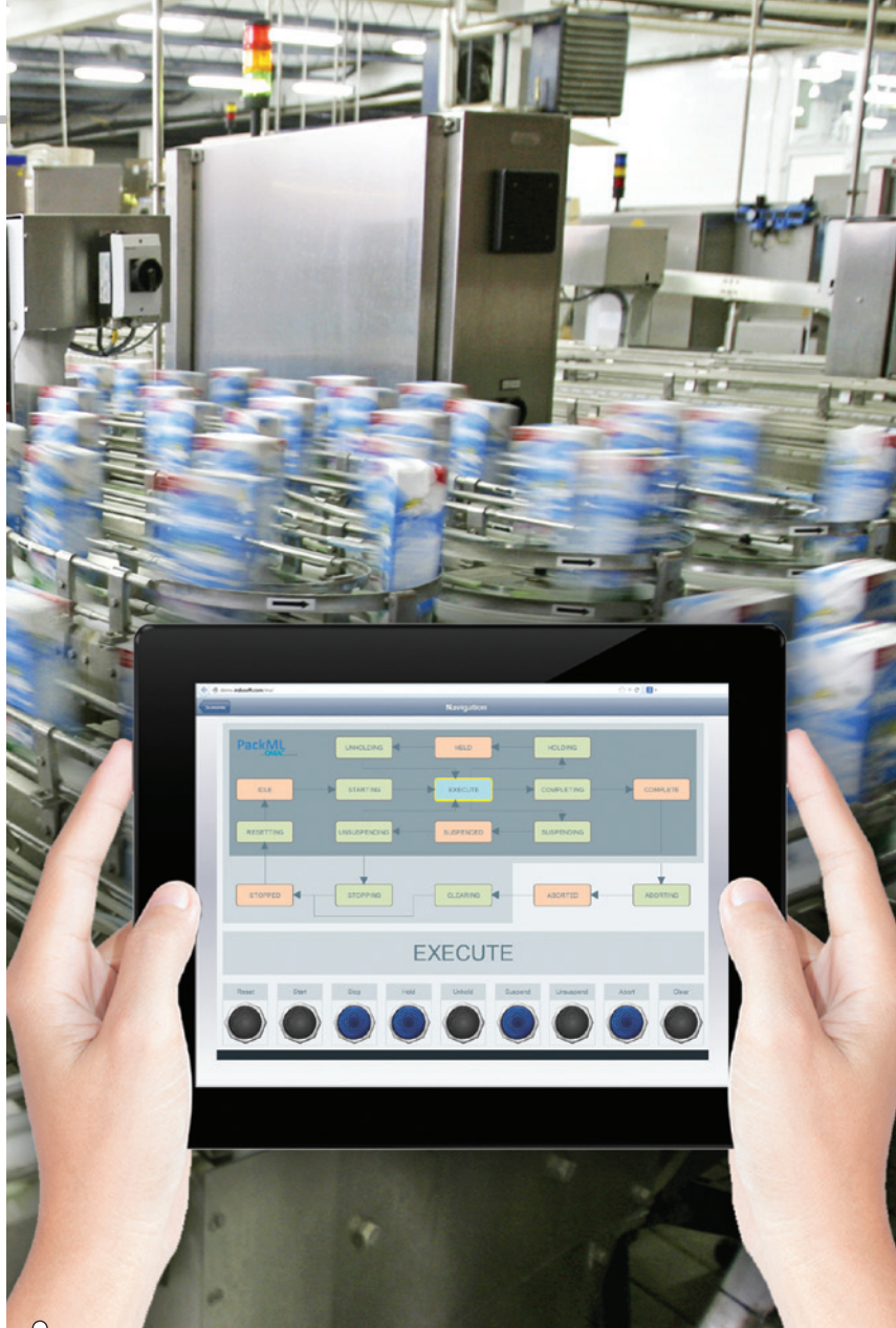
图 1：使用诸如 Indusoft 网页工具包等软件的 HMI 设备，可以为在车间内不断移动的工人提供最新信息。为方便与其它系统的连接和集成，HMI 可以使用内置的模板连接。本文图片来源：InduSoft
