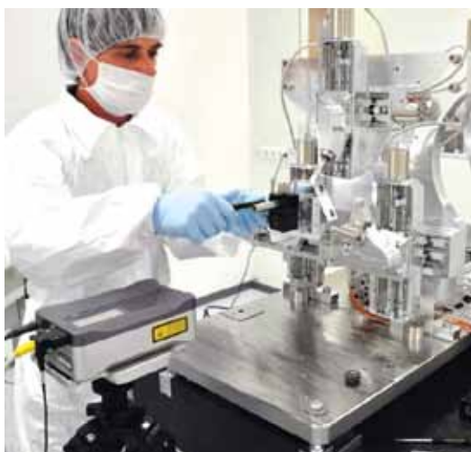
图中所示为光束应用的多轴超高真空定位系统的干涉仪测试。图片来源：PI miCos
