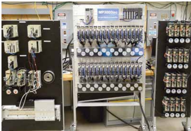
图2：如图中所示的试验台架，可测量性能，并比较伺服系统的特性。
