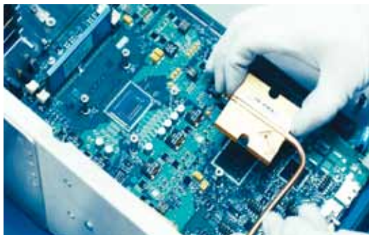
图 2：热阱和传导热管淘汰了经常发生故障的冷却风扇。
