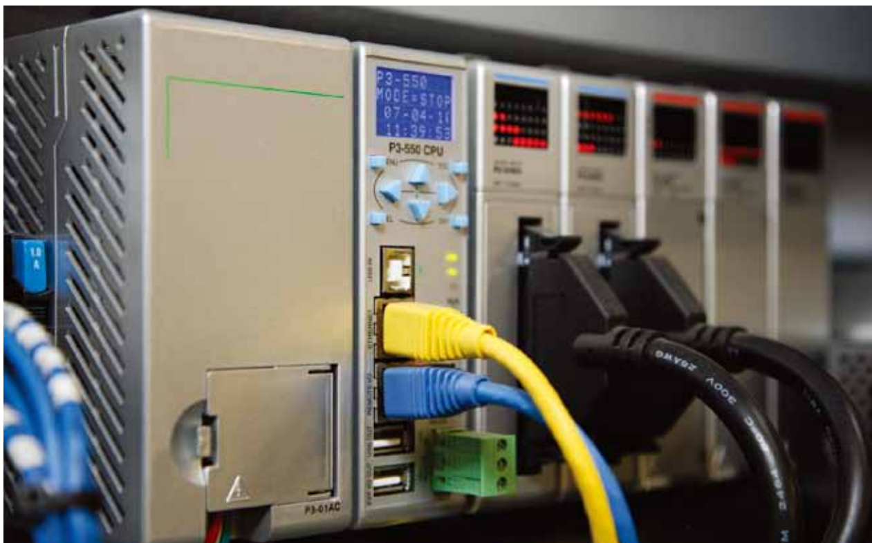
图 1：典型的基于 PLC 的 PAC 系统融合了 PLC 的耐用性和可靠性，同时还有 PAC 的其它很多先进特性。所有图片来源：Automation Direct 公司
