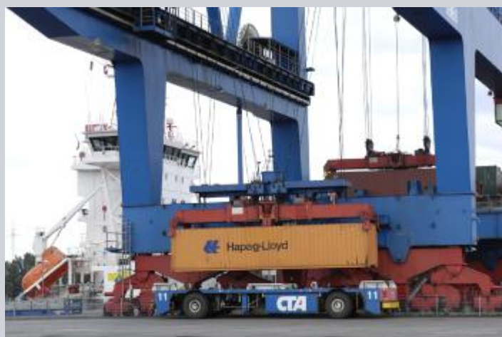
Fig. 2 将集装箱装载到自动导引车
