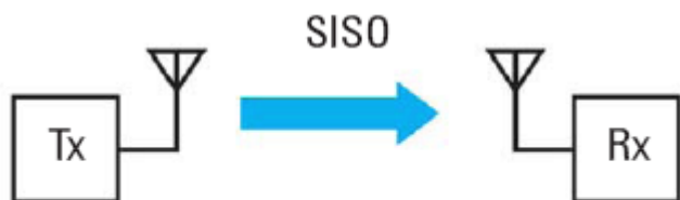
图1 单输入单输出SISO (Single Input Single Output) 系统
