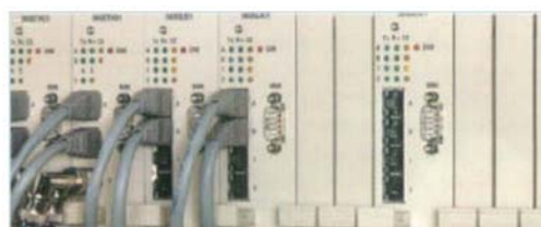
RTU560用于变电站自动化系统 与ABB中国研发中心合作，SoftPLC，Profinet主站
