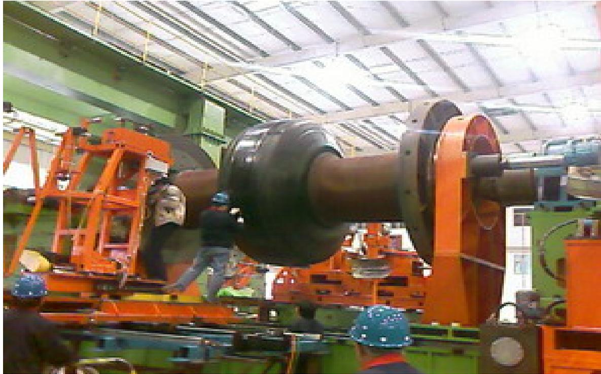
世界上第一台**49/51**特巨型全钢工程子午线轮胎一次法成型机带料试车成功，生产出全世界第一条用一次法成型产的**33.00R51**特巨型全钢工程子午线轮胎。轮胎直径约**3**米，重量达**2.8**吨。
