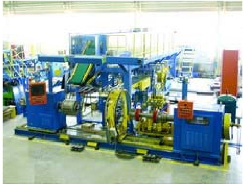
1316乘用/轻卡子午线轮胎一二段成型机现已成功出口意大利。该设备自动化强度高，生产出的轮胎精度高、质量好。因此，受到外商的青睐。
