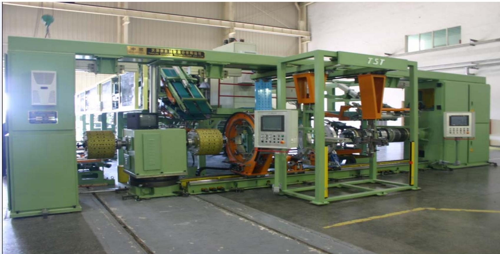
全自动乘用/轻卡子午线轮胎一次法成型机，该设备可用于生产宽断面，低胎侧，最高时速**280**公里的大口径轿车子午胎。我国乘用子午胎的生产的重点企业——华南轮胎公司用这种高性能设备制造出的轮胎已成功打入国际市场
